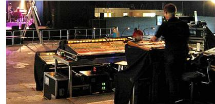
Der Monitorplatz auf der Seitenbühne war durch den Einsatz einer M7CL Konsole von Yamaha überaus aufgeräumt, da das komplette Processing (EQ, Dynamikbearbeitung, Effekte) mit den internen DSP-Funktionen abgewickelt wurde. Durch die Speichermöglichkeiten des Pultes waren auch sehr schnelle Wechsel von der Vorband zum Hauptact des Abends möglich.
